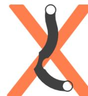
Verwenden Sie das CaliHeat nur bei gedrehtem Beifahrer Sitz um ein knicken des Abluft Schlauchs zu vermeiden!
