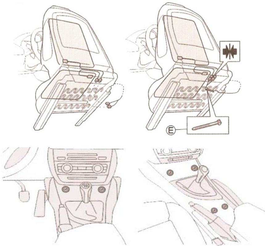
Der Bedienungsschalter wird nach dem Wunsch des Kunden untergebracht. Am häufigsten werden die Bedienungsschalter auf der Mittelkonsole, in der Gegend um den Lenkhebel, auf den Platten in der Nähe des Sitzes montiert. Nach der Auswahl des geeigneten Platzes wird das Loch mit Durchmesser 20mm gebohrt und der Bedienungsschalter angebracht. Danach wird der Bedienungsschalter zum Kabelbündel angeschlossen.
